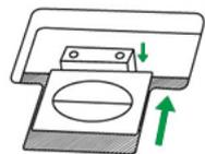
**Siempre desbloqueado** es para el escaneado en una superficie que no sea firme, inestable o demasiado blanda. Además, si coloca el escáner en una posición duradera, también puede dejar el escáner en posición de bloqueo.
